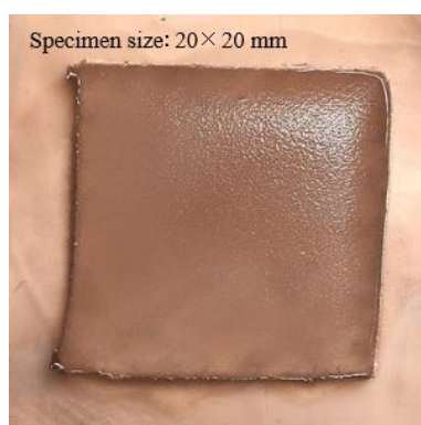
図 4.14 冷凍庫によるエチレングリコール水溶液（モル分率 0.031）の 固化状態
