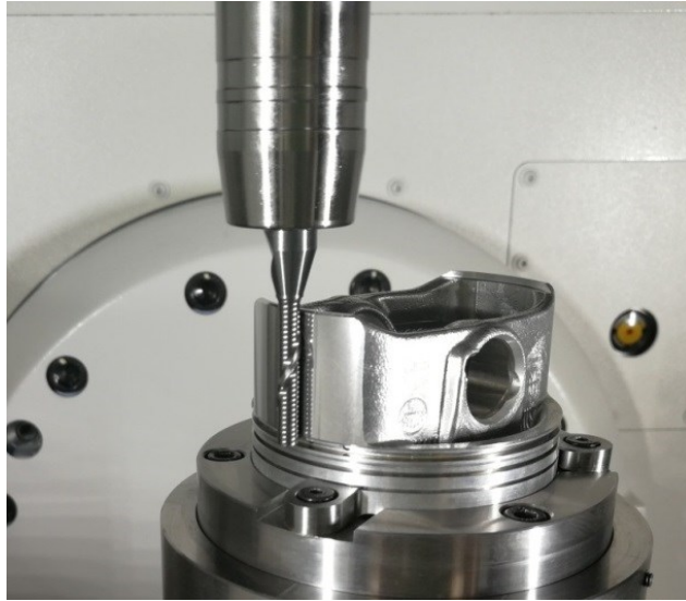
Fig. 6.7 微細断続切削加工によるピストンスカート部の加工
