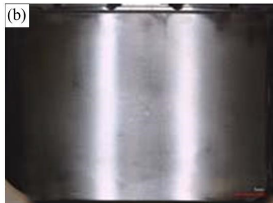
Fig. 6.8 自動車ピストンへの固体潤滑剤複合化
