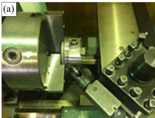
Fig. 6.8 自動車ピストンへの固体潤滑剤複合化
