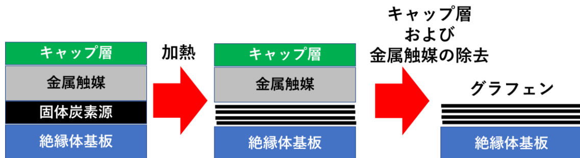
図 1.4 キャップ層を用いた析出法によるグラフェンの直接成長
