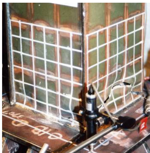
写真-1.2 厚肉断面鋼製橋脚供試体の基部に生じたき裂による破断と局部座屈 6)
