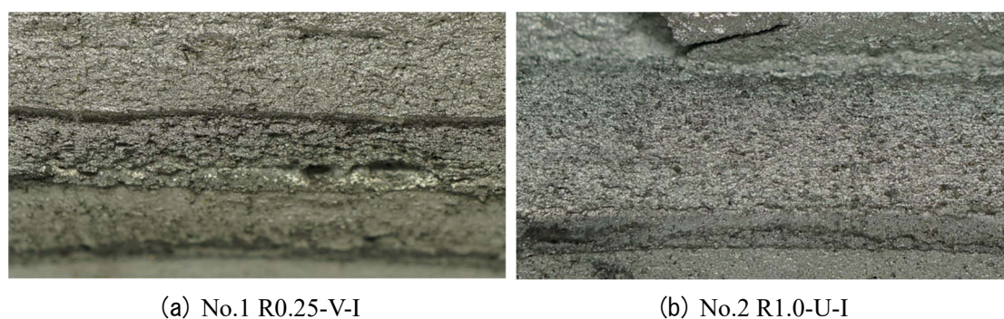
写真-5.4 破断面中央部の拡大写真
