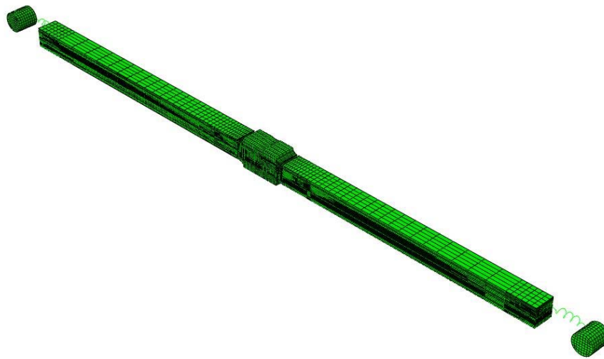
図-6.5 三点曲げ試験体の解析モデル概要図 (Half モデル)
